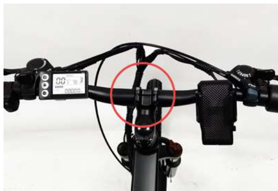
Installare il manubrio e stringere le viti con la chiave esagonale n.4
