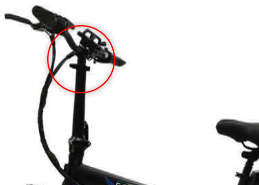
Stringere le viti del montante con la chiave esagonale n.5
