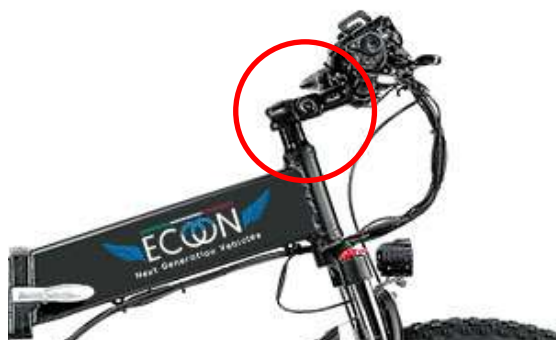
Stringere le viti del montante con la chiave esagonale n.5
